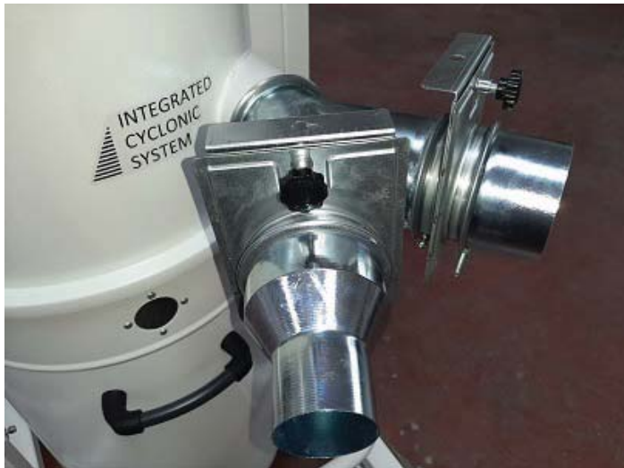
Schließer zur Optimierung des Luftvolumens
