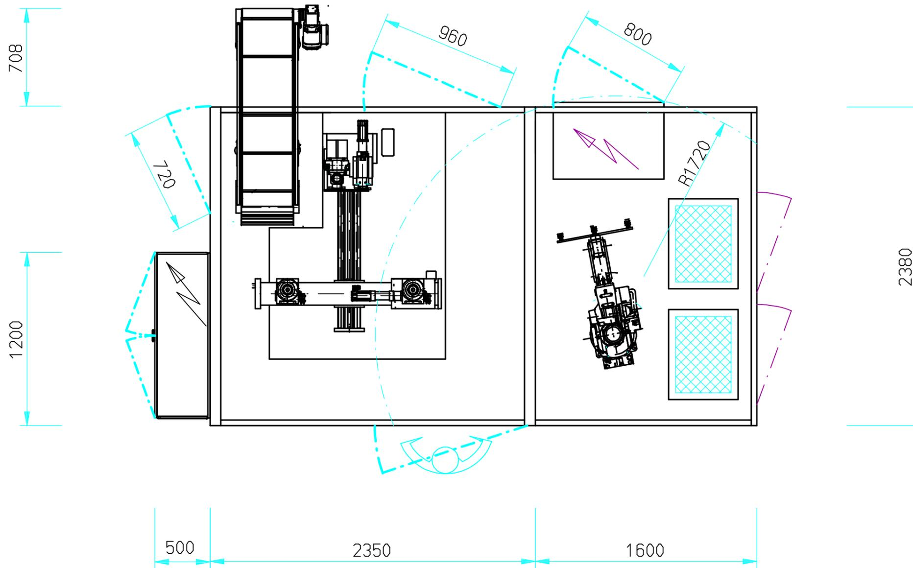
Handling Multilayerbesäummaschine MBM 443
