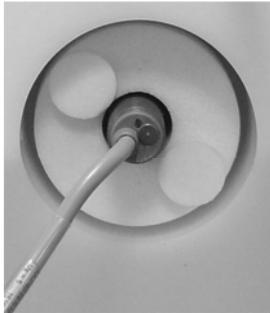
ALMATEC Membranen mit integriertem Metallkern sind auf optimale Lebensdauer ausgelegt. Dennoch ist eine Membrane ein Verschleißteil. Im Falle eines Membranbruchs kann Fördermedium in den Steuerblock der Pumpe gelangen und ggf. am Schalldämpfer austreten. Dies lässt sich sehr einfach mit der ALMATEC Membranüberwachung verhindern.
