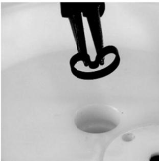
Zunächst die O-Ringe [20] einbringen. Es müssen neue Kolbenringe [20] verwendet werden. Zur Montage den Kolbenring [20] mit einer Sicherungsringzange vorsichtig nierenförmig biegen und in die Nut einsetzen. Danach die Aufwölbung des Kolbenrings [20] mit einem runden Gegenstand vollständig in die Nut drücken. Mit sauberem Zuganker [13] ausrollen. Schließlich die Kolbenstangenhülse, lang [39] einsetzen, und zwar an der Seite an dem sich der große Zylinderbuchsen-O-Ring [38] befindet.
