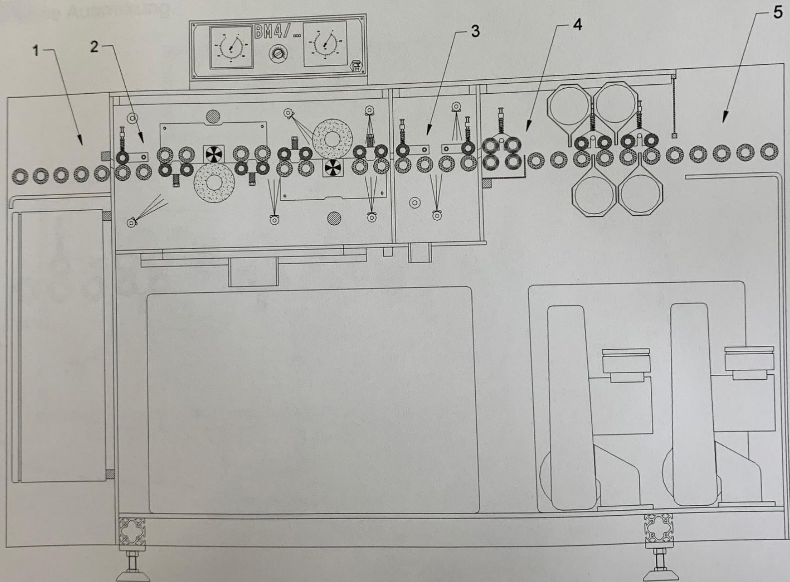
**Baugruppen:** ① Einlaufzone ② Bürstkammer ③ Spülkammer ④ Trockenzone
